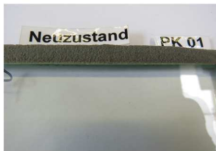
Bild 1 und 2 Probekörper 1 im Neuzustand und nach 7 Wochen 60 °C-Lagerung
